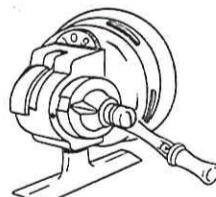
När "ON" är mitt för pilen är spärrkontrolen (knarren) påkopplad under invevningen samt även när veven går baklänges.
