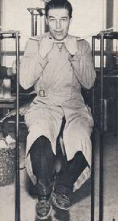
En 12 mm massiv glasfiberstav som användes i Arjon-spön håller hans 78 kg.
